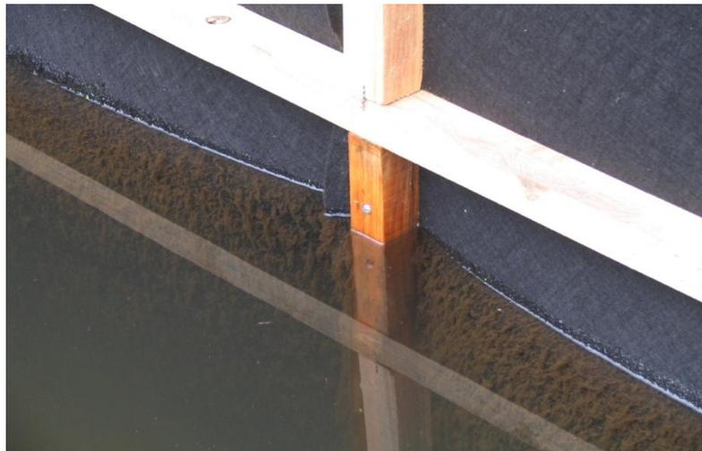
**Figura 14. Formación de la capa de lodo en la superficie del tamiz**
