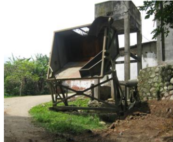
Fotografías 74, 75,76 y 77 Zona de descargue de los residuos líquidos y sólidos sin previa separación. y camino de desplazamiento de los residuos por donde escurría el agua sangre hacia los tanques sépticos que no estaban en funcionamiento.
