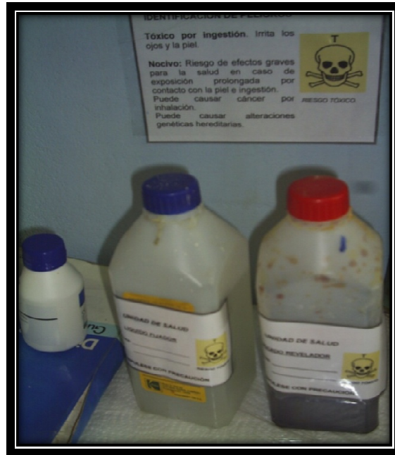
Figura 59. Pictogramas colocados en almacenamiento de líquidos revelador y fijador.
