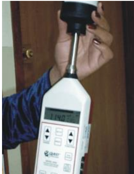
Figura 4. Calibración con pistófono del Sonómetro Quest 2900
