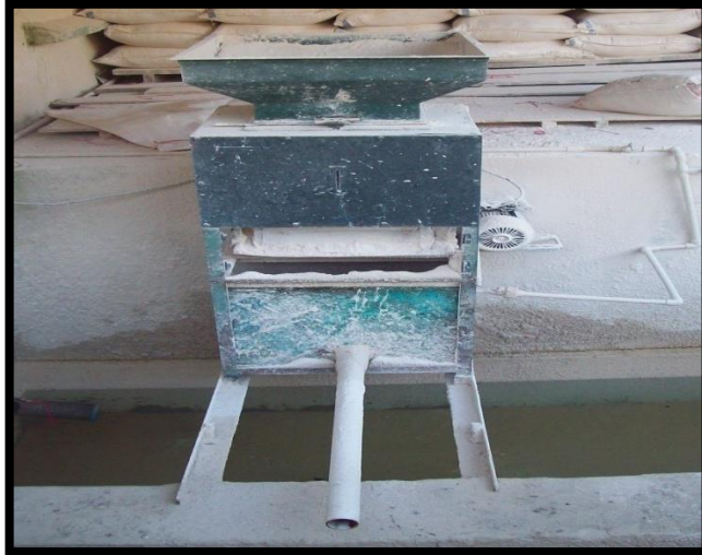
Figura 59. Único equipo dosificador de cal
