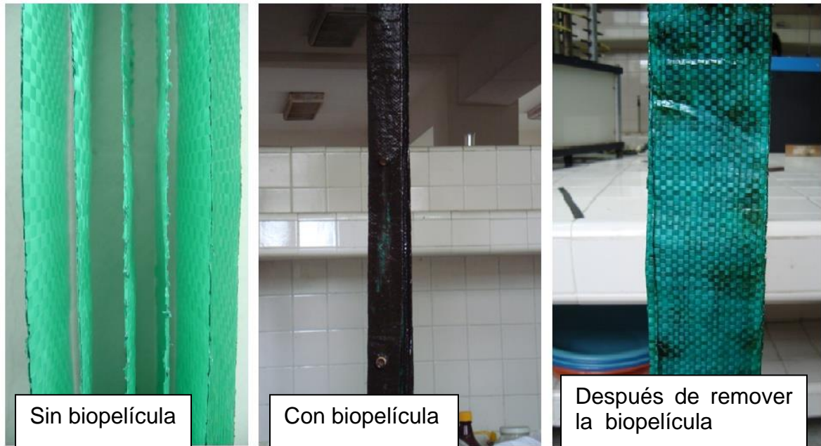
Fotografía 6. Apariencia de las franjas tejidas de polietileno antes y después de la permanencia en el interior del reactor.
