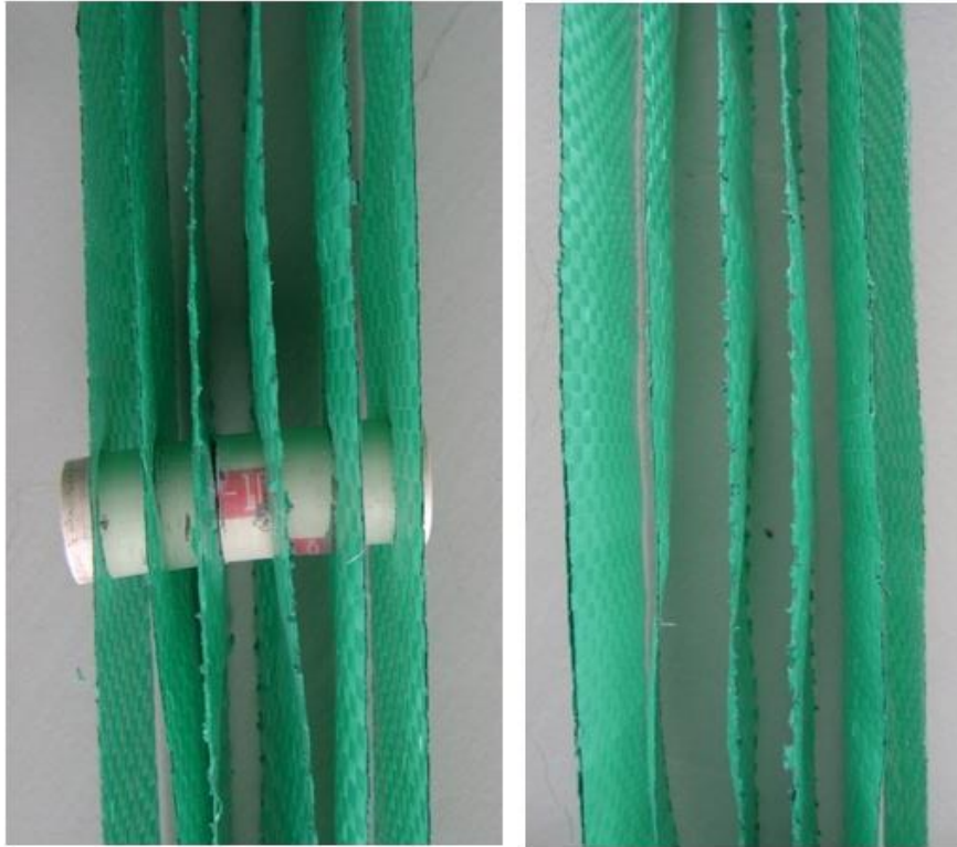
Fotografía 4. Ubicación de las franjas tejidas de polietileno al interior del reactor.
