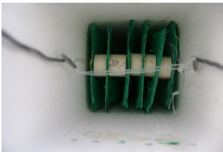
Fotografía 4. Ubicación de las franjas tejidas de polietileno al interior del reactor.
