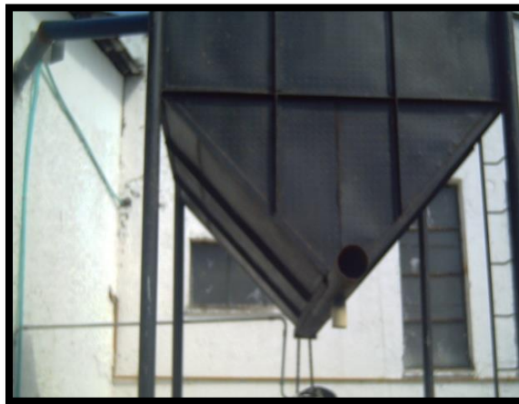
Figura 10. Tolva para la recolección de contenido ruminal. Central de Sacrificio de Popayán
