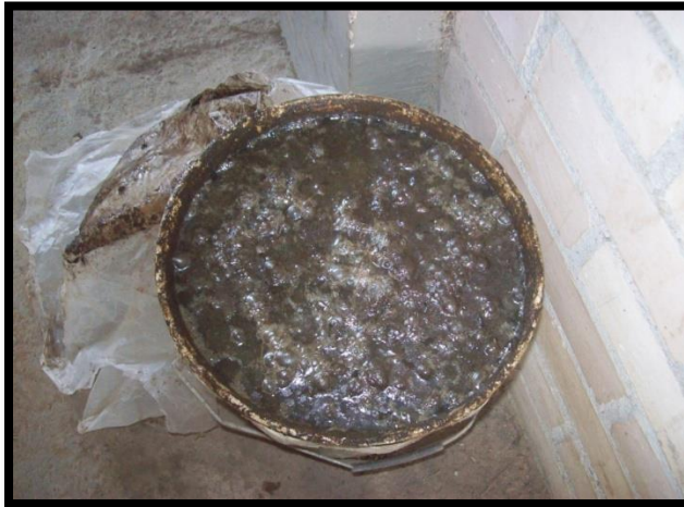
Figura 12. Residuos después de 3 meses de ensilaje. Relleno Sanitario “El Ojito”
