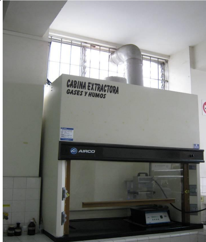
Figura F 3. Campana de extracción
