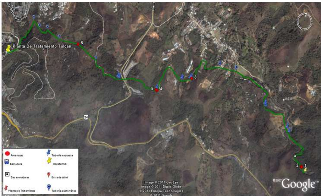
Figura 1. Sistema conducción agua cruda, bocatoma-planta de tratamiento de Tulcán
