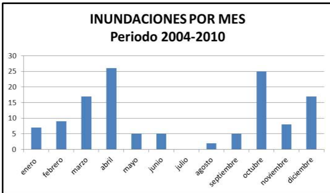
Figura 34. Inundaciones del sistema de alcantarillado por mes para el periodo 2004-2010
