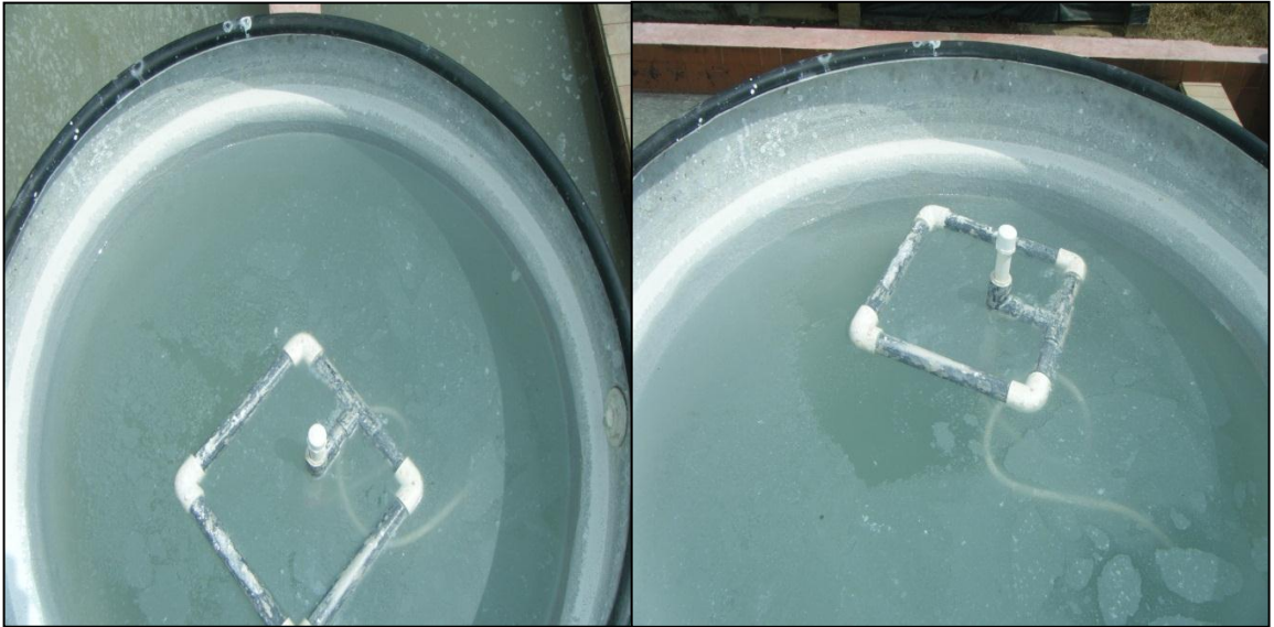
Foto 3. Flotador de cabeza fija para la dosificación de cal
