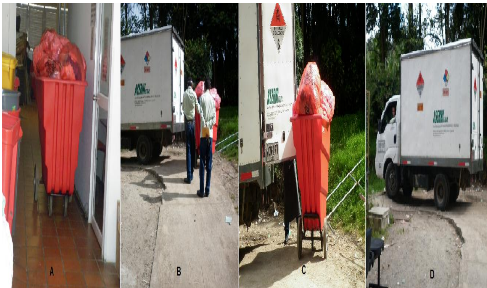
Figura 17. Procedimiento de recolección de residuos peligrosos por parte del agente externo ASERHI. A. Transporte de los residuos peligrosos desde el cuarto de almacenamiento central de residuos. B. Llegada del carro contenedor de residuos peligrosos al carro de ASERHI. C. Carga de los residuos peligrosos al carro de ASERHI. D. Salida del carro de ASERHI hacia la planta incineradora.
