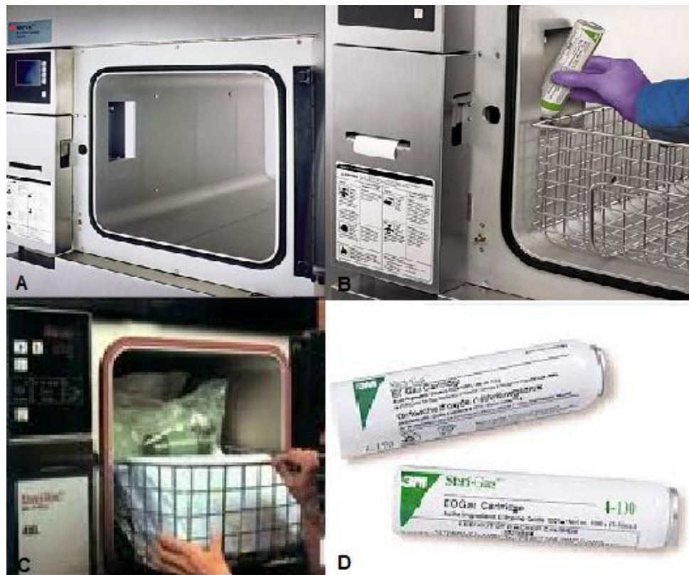
Figura 2. Equipo y aireador por gas 3M™ Steri – Vac™. A. Interior del equipo Steri – Vac™. B. Instalación del cartucho Steri – Gas™ en el equipo. C. Disposición de material quirúrgico a ser esterilizado. D. Presentación de los cartuchos Steri – Gas™ de una sola dosis que contienen óxido de etileno al 100%.
