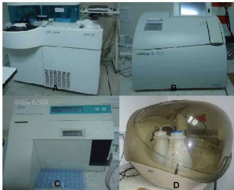
Figura 5. Equipos Área Química Clínica. A. Analizador Cobas c311. B. Analizador Cobas b 121. C. Analizador de Electrolitos 9180. D. Analizador automático Radom Access Analyzer A15.
