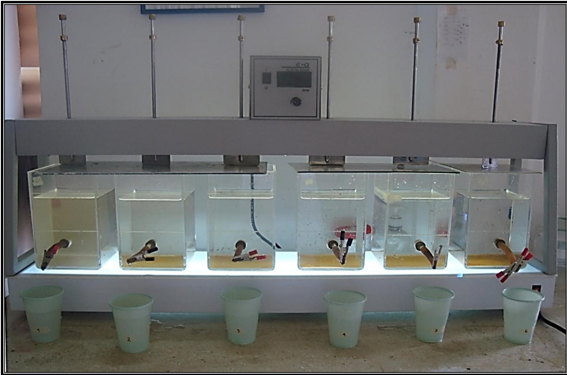
Fotografía 3. Detalle Equipo y Prueba de Jarras
