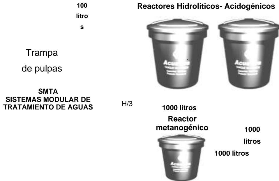
Figura 4. Esquema del sistema modular del tratamiento anaerobio (SMTA)
