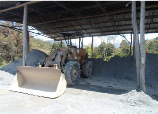
Cargador 955K, carga material de base, sub-base y piedra filtro
