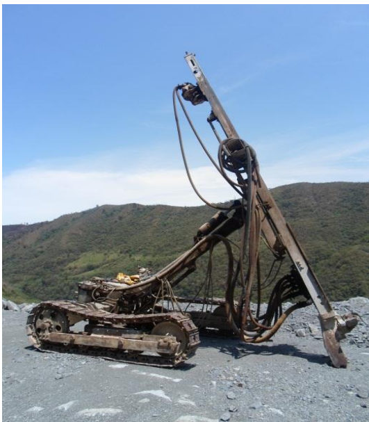
Track Drill que se encarga de perforar
