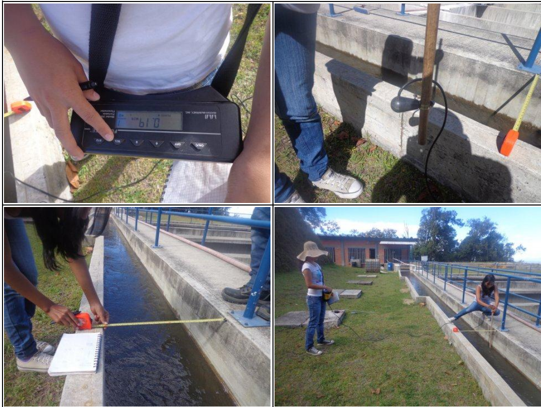
Figura 7. Medición del Caudal en el tercer tramo del canal de entrega a los floculadores
