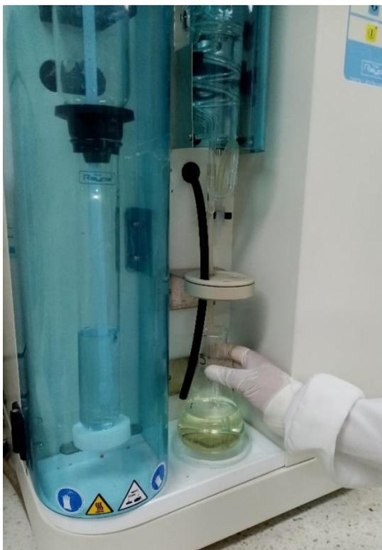
Figura 8. Determinación de extracto etéreo
