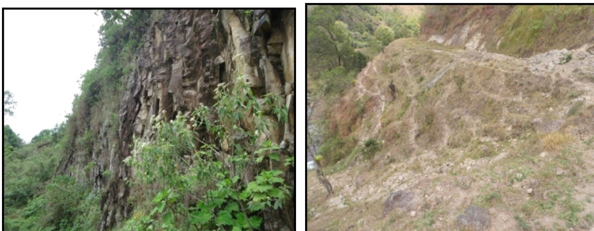
Grado de meteorización de los taludes rocosos con pendiente vertical y saturación de los suelos cerca del Río.
