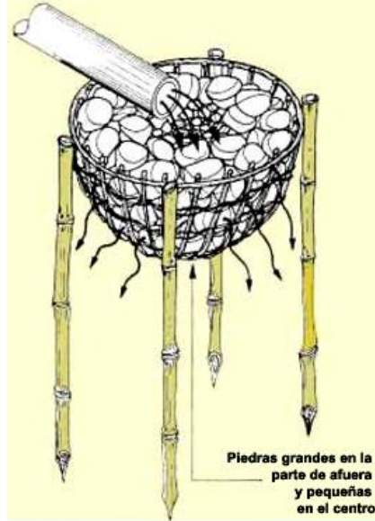
Figura 14. Cesta filtrante llena de piedras colocada debajo de la entrada del agua
