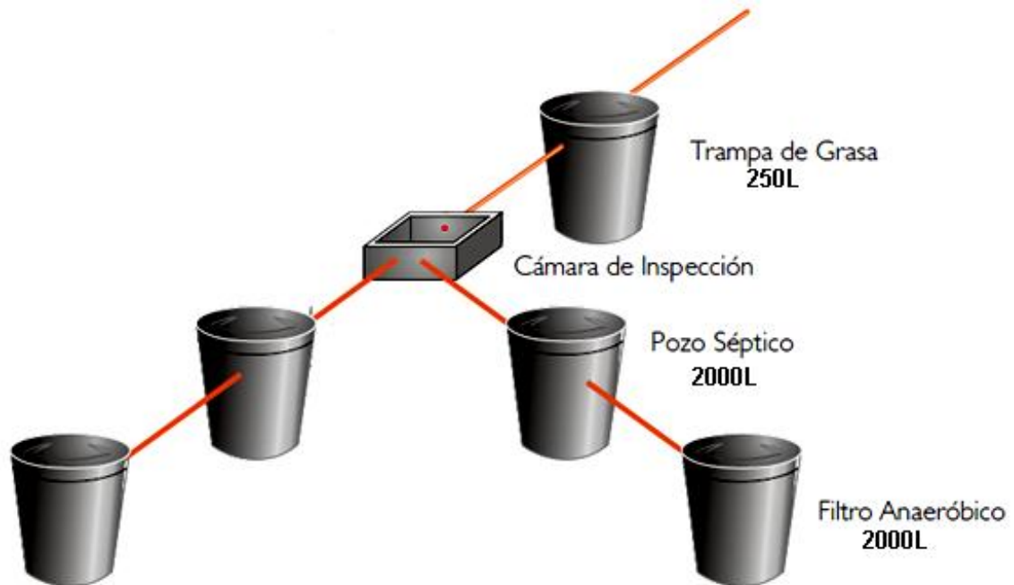
Figura 46. Sistema en paralelo después de la trampa de grasas.
