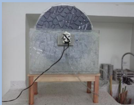
Foto 4. Observación: montaje del sistema RBC en acrílico Fecha: agosto de 2014
