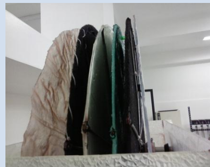
Foto 3. Observación: discos en acero inoxidable cubiertos en tela verde , acrílico, geotextil y plástico Fecha: julio de 2014
