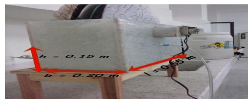
Ilustración 3. Dimensiones del reactor
