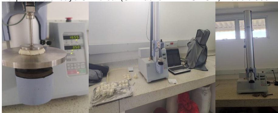
Figura 2. Máquina de ensayo Universal (Shimadzu EZ TEST SM, modelo 500N-169)
