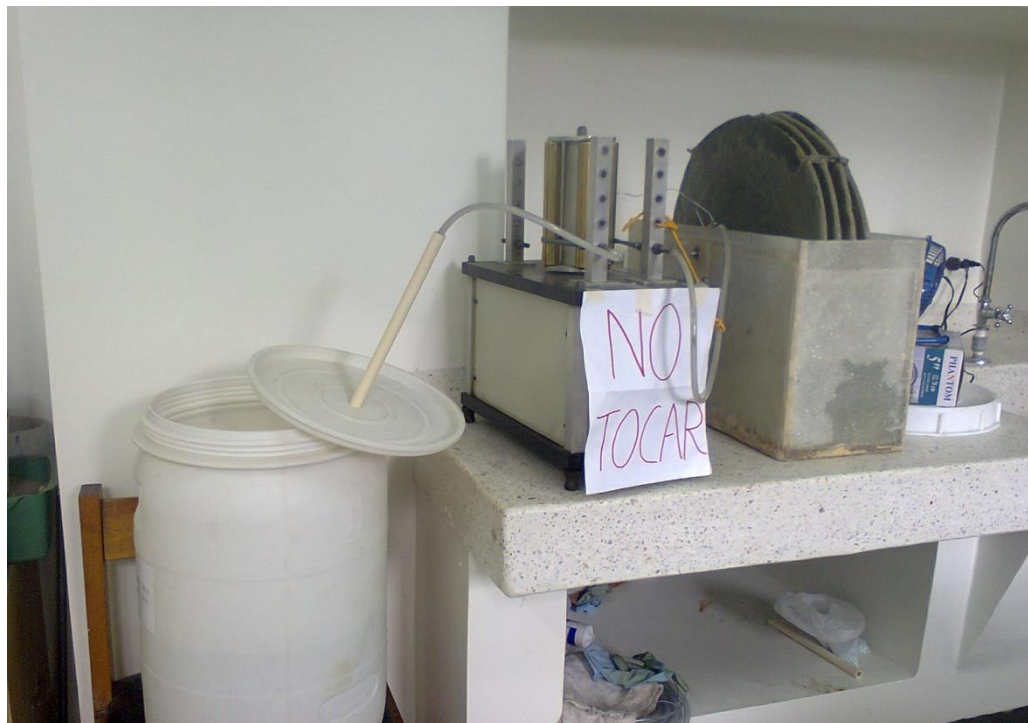
Imagen 2: Sistema de biodiscos.
