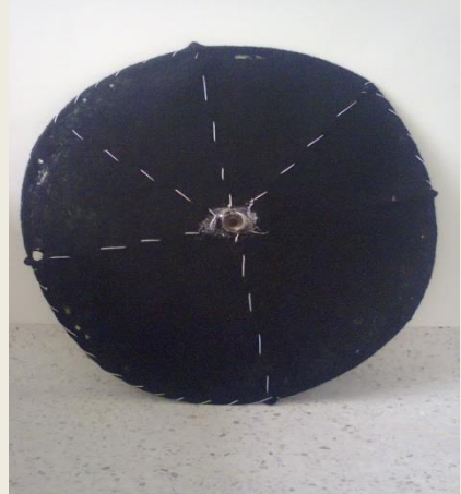
Foto 3. Disco elaborado con geotextil NT 1600
