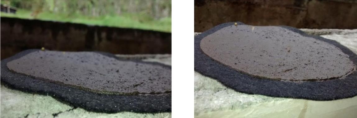
FIGURA 8. Formación de torta de lodo en la superficie del medio filtrante. Fuente: Collazos y Méndez (2015).
