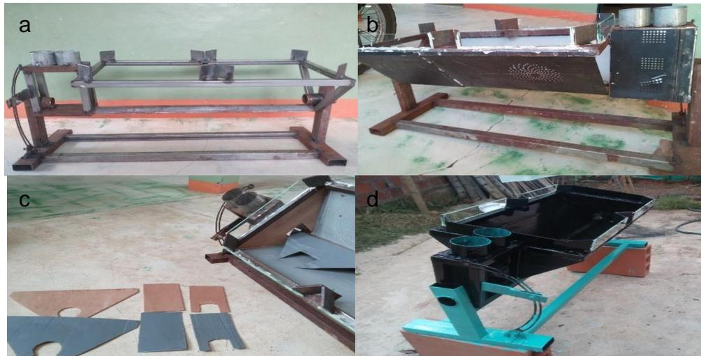
**Figura 3-2: Estructura final ensamblada del soporte del UAS**
