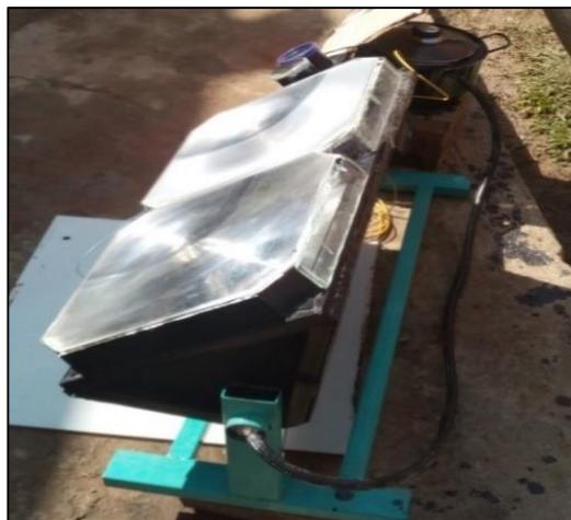
**Figura 4-3: UTT del prototipo termosolar 2 modificada**
