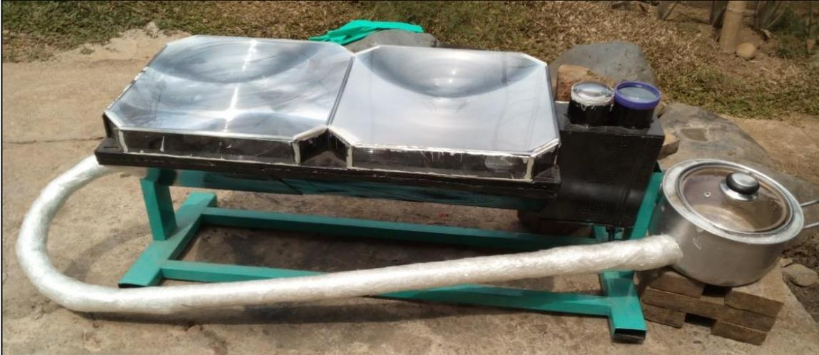
**Figura 3-8: Prototipo termosolar 2 ensamblado en su totalidad**
