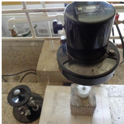
Figura 4.4 Equipo usado para medir la variación de la viscosidad de las suspensiones: Viscosímetro Brookfield Serie LV.
