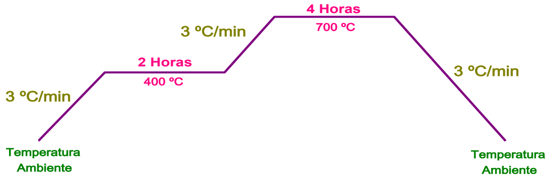
Figura 4.7. Programa de calentamiento usado para tratar térmicamente las piezas cerámicas de ZnO comercial.
