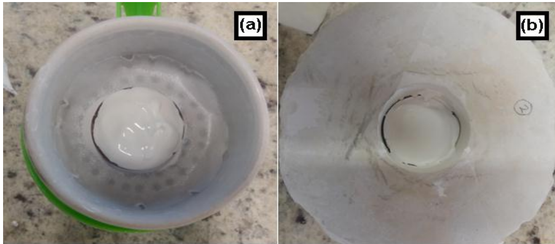
Figura 2. Barbotina coagulada con hidróxido de amonio: (a) filtrando y (b) colocado sobre el molde (método slip casting).
