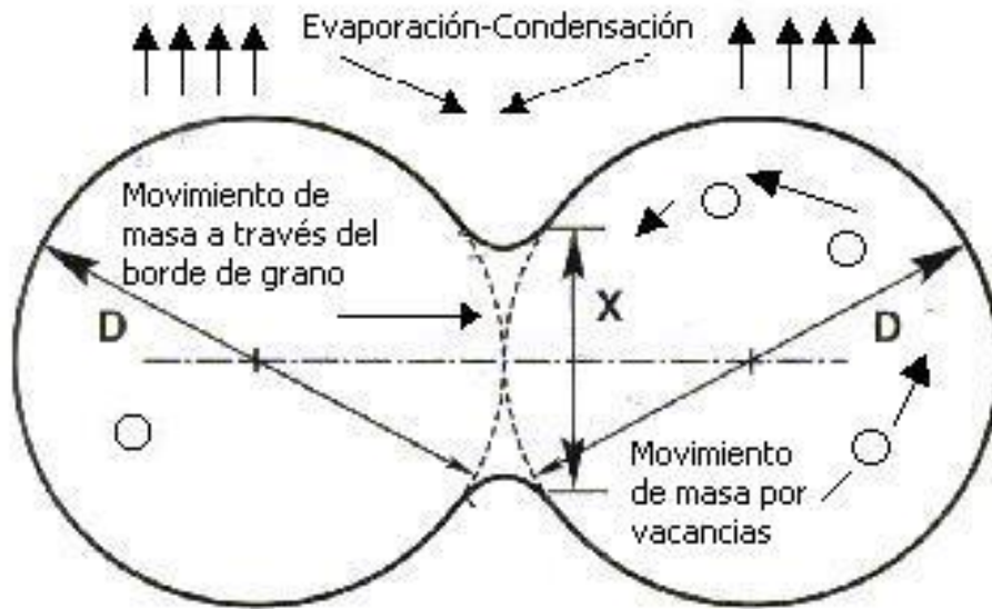
Figura 2.15. Esquema del flujo de materia en el proceso de sinterización. [31]
