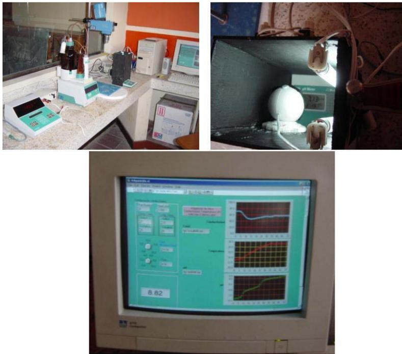
Figura D3 – imágenes de los equipos empleados para la síntesis, el sistema de iluminación y la cámara web, y aspecto de Core Integrado durante un proceso de síntesis en CYTEMAC.
