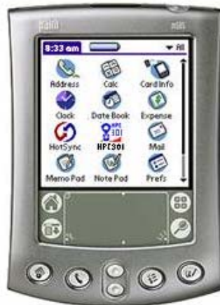
Figura 6. Vista frontal terminal de mano HART de computadora de bolsillo
