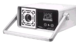
Figura 6.1. Calibrador de bloque metálico
