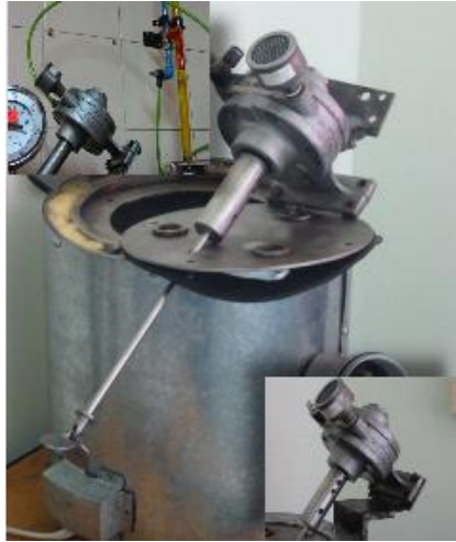
Fotografía 8.14. Motor neumático, helice y válvula de estrangulamiento
