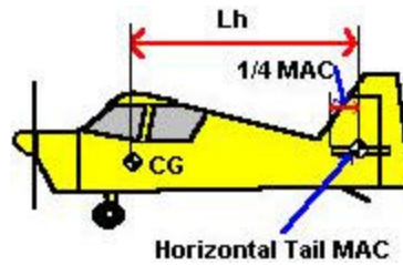
Figura 5.16 Relación entre las dimensiones de la cola horizontal
