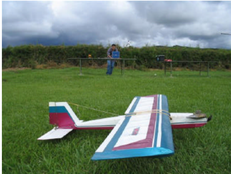
Figura 2.17 Ala Rectangular (Prototipo utilizado en éste trabajo de grado)
