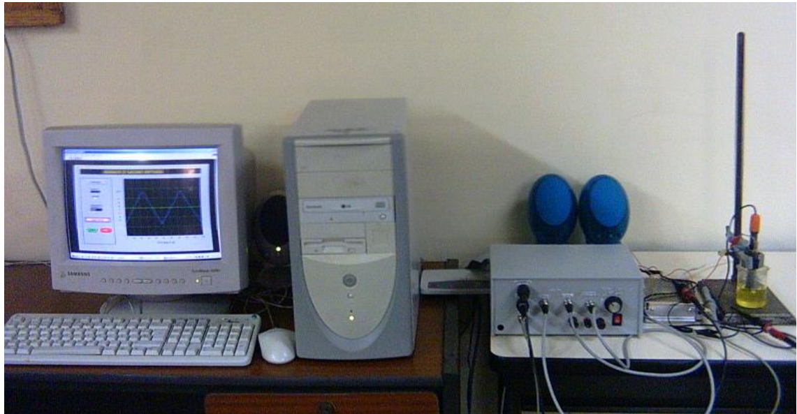
Figura 31. Sistema para voltamperometría potenciostático construido en la Universidad del Cauca
