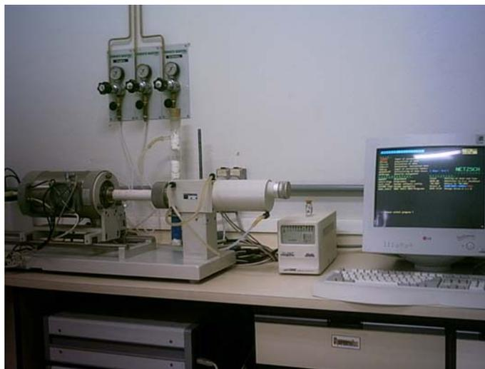
Figura 5.5 Dilatómetro modelo Netch 402E.
