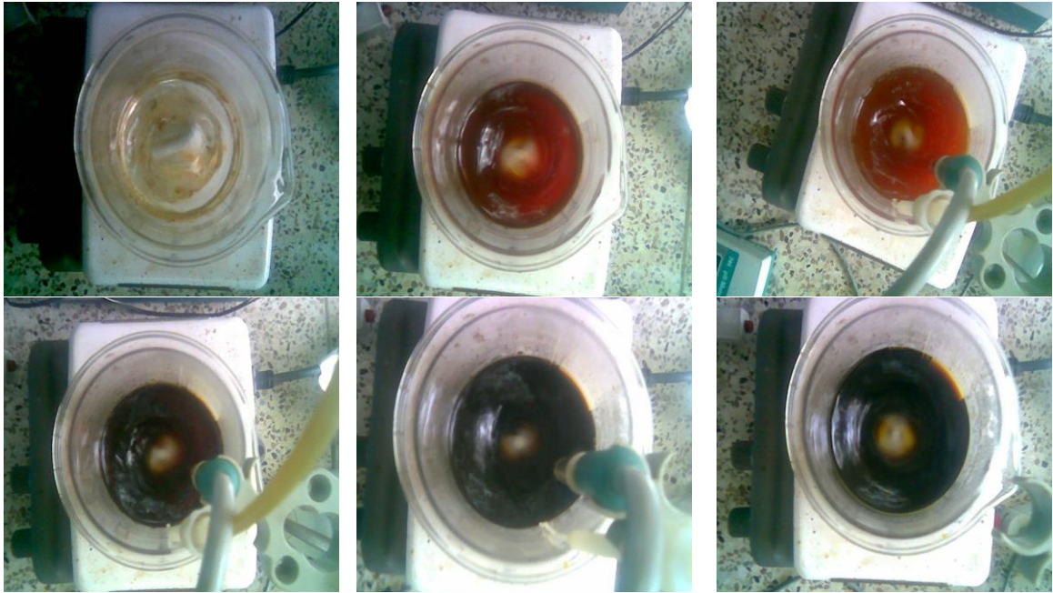
Figura 5.5. Imágenes de las diferentes fases del proceso de síntesis de la hexaferrita de bario por medio del método Pechini.
