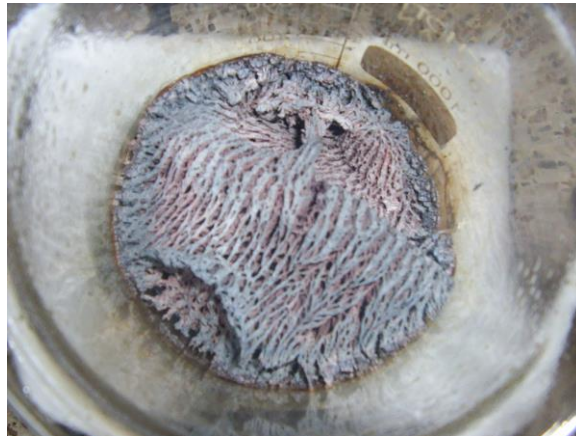
Figura 5.4. Ceniza obtenida en el proceso de síntesis de BaFe 12 O 19 por Pechini
