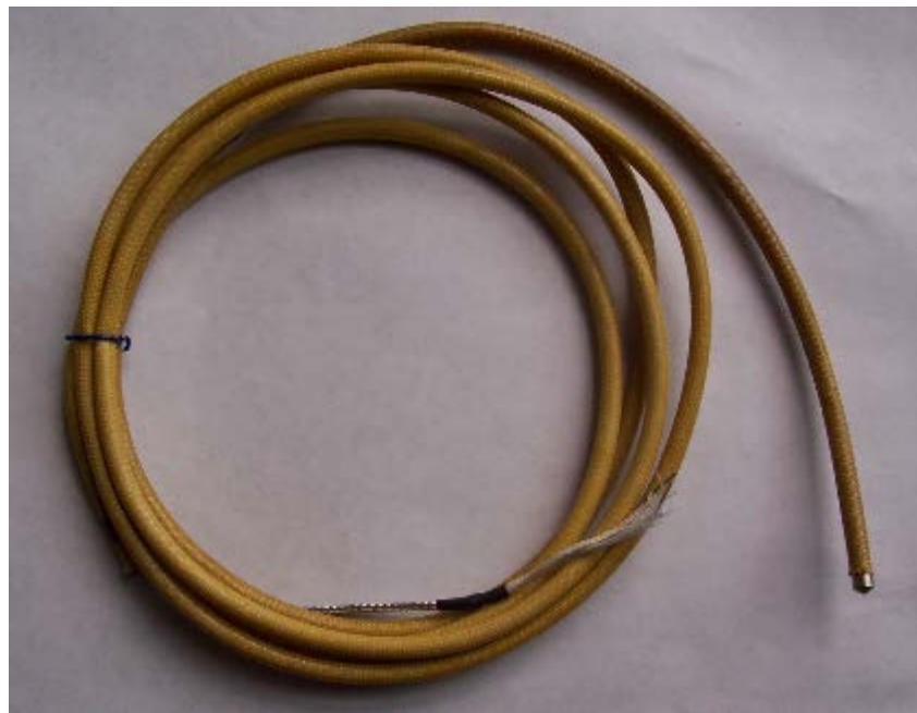
Figura 3.8 Termocupla tipo J recubierta con funda térmica.
