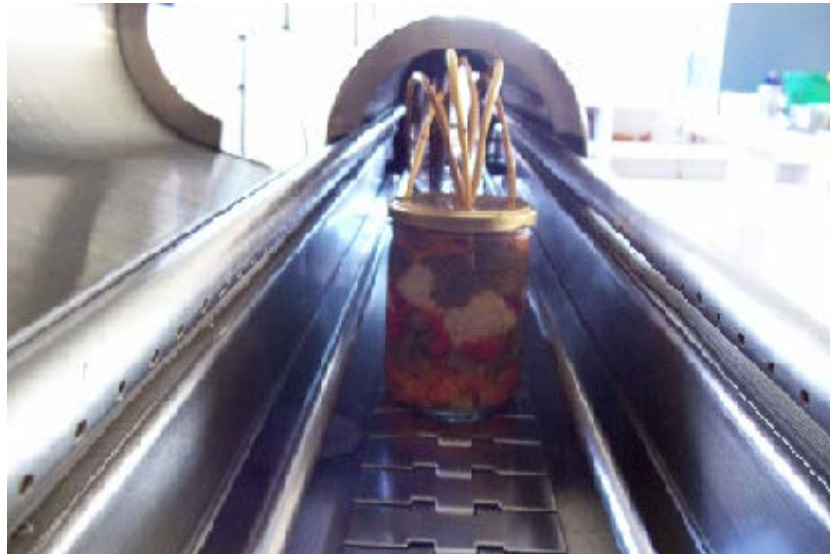
Figura 3.16 Exhausting y producto alimenticio con las termocuplas.
