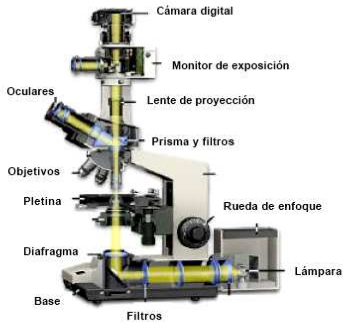
Figura 9. Esquema del microscopio de luz con la trayectoria de la luz.
