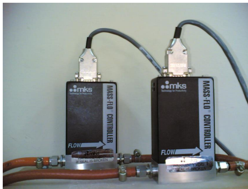
Figura 12b. Controladores de flujo de gas.
