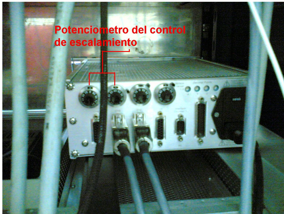
Figura 12c. Cara opuesta de la unidad de poder con set point, potenciómetros de calibración
