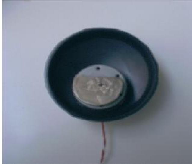
Para modificar su velocidad se puede variar su tensión de alimentación con lo que el motor perderá velocidad, pero también perderá par de giro (fuerza) o para no perder par en el eje de salida se puede hacer un circuito modulador de anchura de pulsos (pwm) con una salida a transistor de mas o menos potencia según el motor utilizado.
