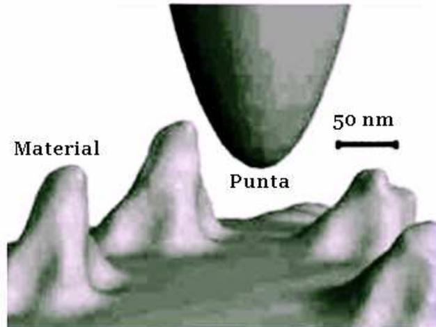
**Figura 29** Punta de cristal, situada en el cantilever
