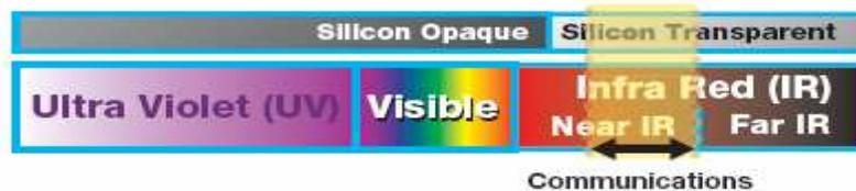
**Figura 19** El silicio es transparente a longitudes de onda de 1.3 a 1.6 micras.
