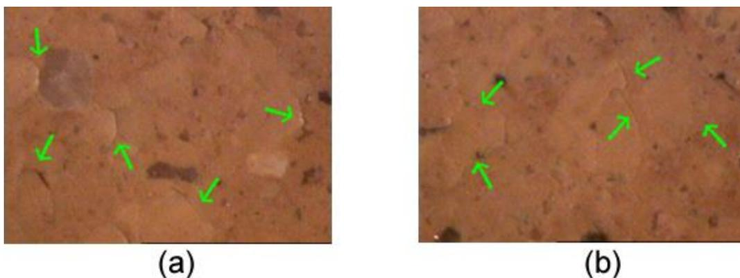
**Figura 5.33. Fotografías de la superficie de la muestra ARGU-I sinterizada a 950° C y atacada térmicamente a 900° C.**
