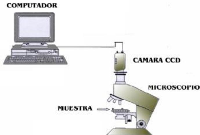
**Figura 4.5 Sistema de adquisición de imágenes de la Unidad de Microscopía Electrónica de la Universidad del Cauca**
