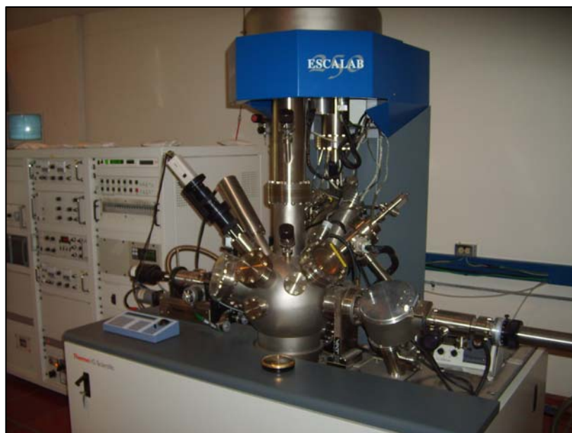
Figura 6.10. Fotografía del espectrómetro de fotoelectrones de rayos X, XPS, empleado en este trabajo para caracterizar los recubrimientos obtenidos.
