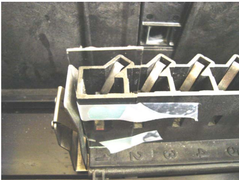
Figura 6.12. Fotografía que indica la ubicación del recubrimiento sobre el portamuestras de la celda del espectrofotómetro
