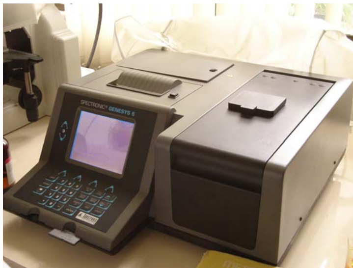
Figura 6.6. Fotografía del espectrofotómetro UV-Visible empleado para la caracterización de los soles.
