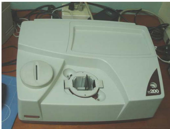
Figura 6.5. Espectrofotómetro IR empleado para la caracterización de los soles conformados.
