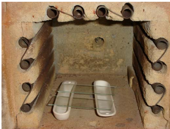
Figura 6.4. Interior del horno empleado para la sinterización de las películas.
