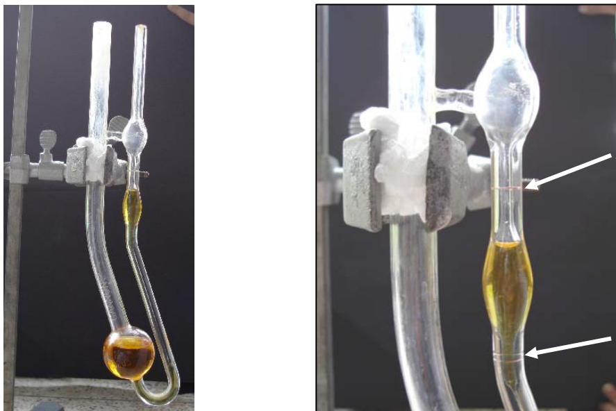
Figura 6.7. Esquema del viscosímetro tipo Ostwald utilizado para el estudio de variación de viscosidad de los soles.
