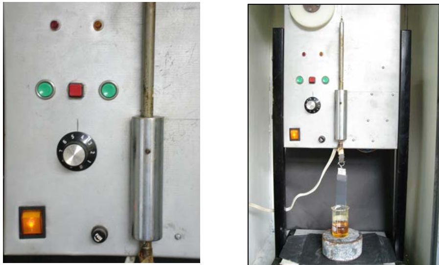
Figura 6.3 Ascensor empleado para realizar la inmersión-extracción
