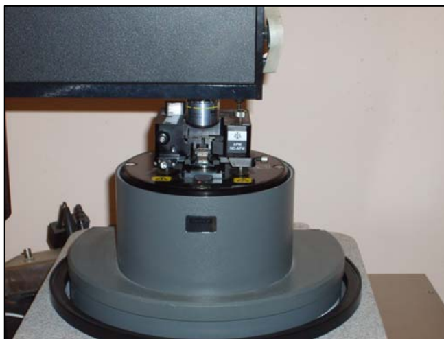
Figura 6.9. Fotografía del microscopio de fuerza atómica, MFA, empleado para la caracterización de los recubrimientos obtenidos.
