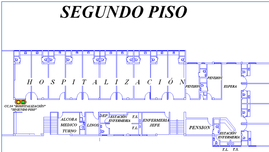
Figura 43. Ubicación de sensores segundo piso
