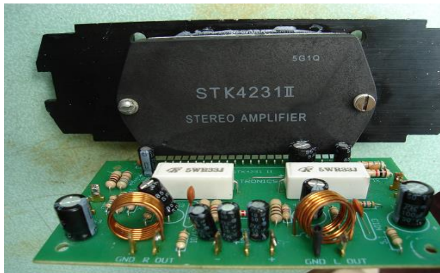
Figura No. 7: Tarjeta de acondicionamiento y amplificación
