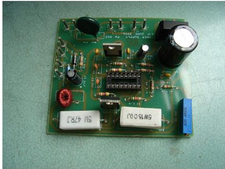
Figura No. 18: Montaje y soldadura de la tarjeta de la fuente de alimentación para el proyecto BMS.
