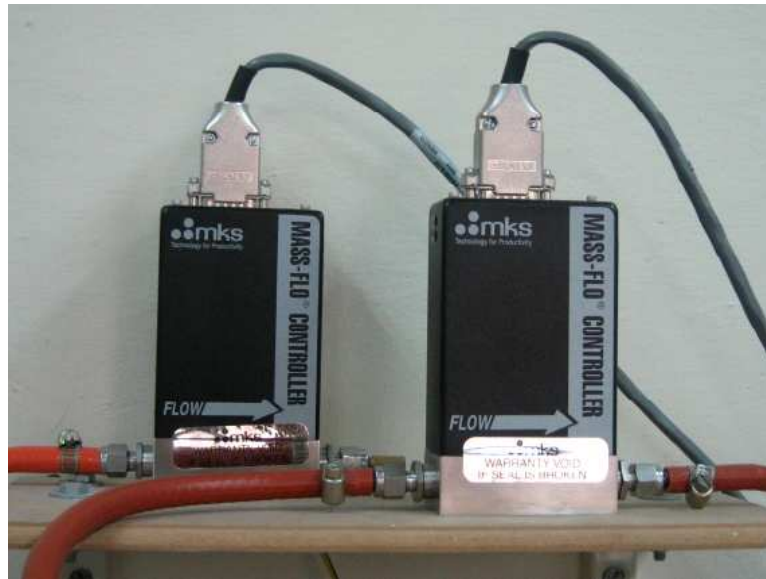
Figura 26. Controladores de flujo o fluxómetros.
