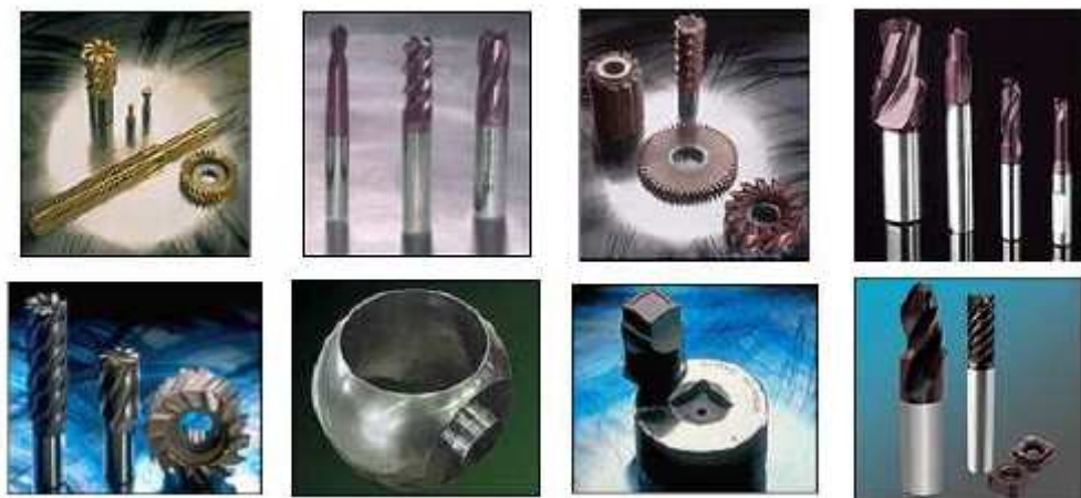
Figura 12. Herramientas con una diversidad de recubrimientos duros crecidos por PVD, por ejemplo: TiN, TiCN, TiCN - MP, TiAlN, AlTiN, CrN, CB_C y TiAlCN.
