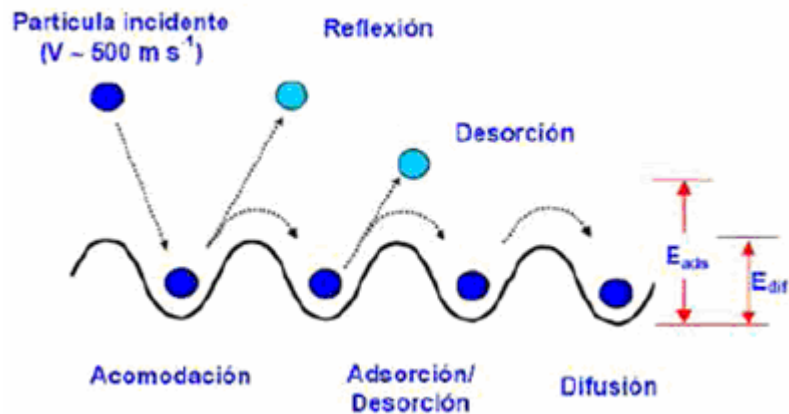
Figura 20. Esquema de las etapas iniciales de la llegada de átomos a una superficie y de los procesos adsorción – desorción y difusión simultánea en la superficie [5].
