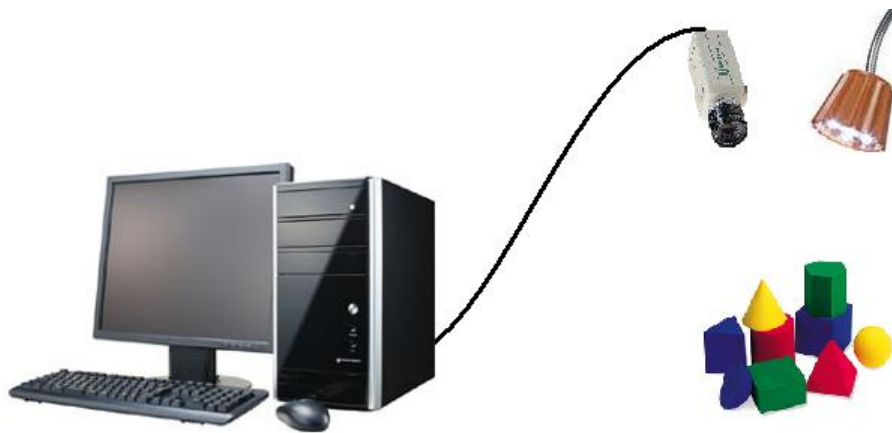
Figura 2.1. Componentes de un sistema de visión artificial.
