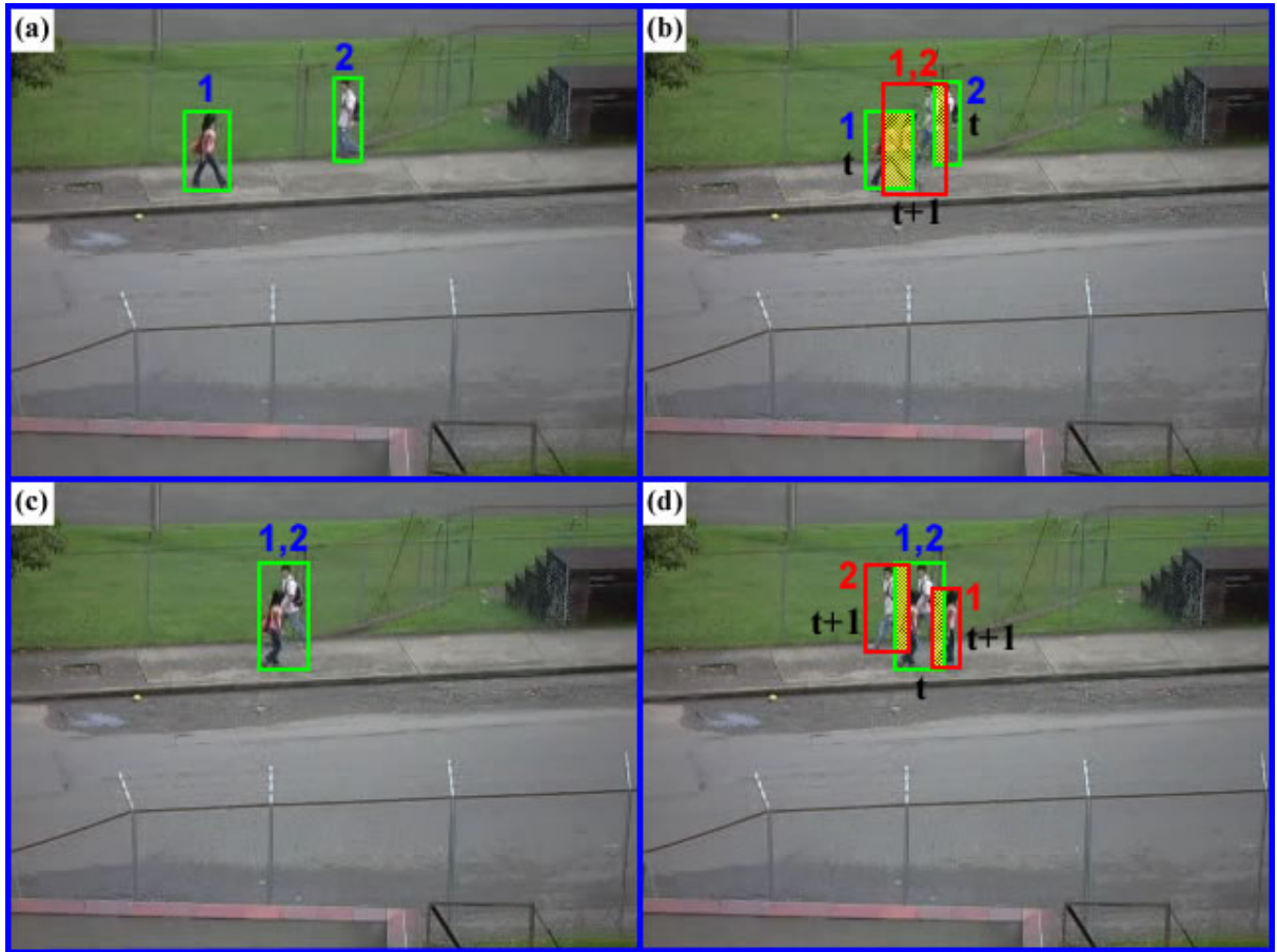
Figura 4.9. Solución de problemas de oclusión: (a) Objetos 1 y 2 moviéndose en direcciones contrarias. (b) Formación de un grupo. (c) Seguimiento, como objeto individual, del grupo conformado. (d) Separación del grupo.
