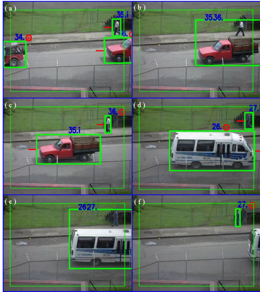
Figura 5.14. Errores en la asignación de las respectivas etiquetas a los objetos de interés. (a) y (d) Etiquetado, inicialmente correcto. (b) y (e) Agrupamiento de objetos de etiquetas diferentes. (c) y (f) Error en la asignación de las etiquetas correspondientes.
