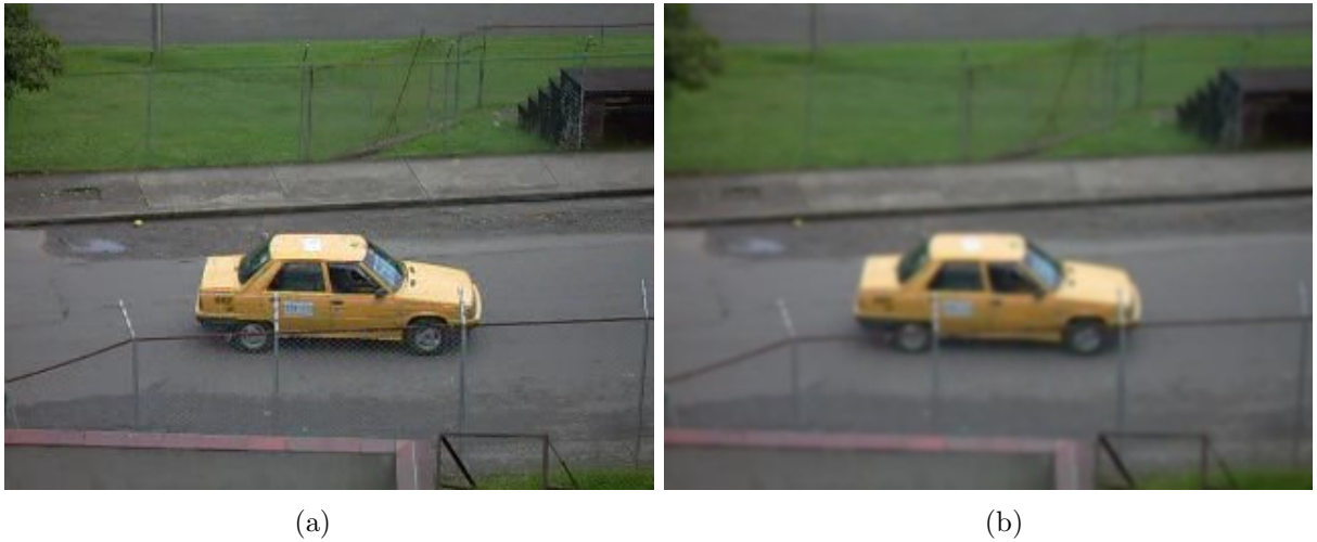
Figura 2.22. Filtrado espacial de paso bajo: (a) Imagen original. (b) Resultado de la aplicación del filtro de paso bajo mostrado en la figura 2.21 (a).
