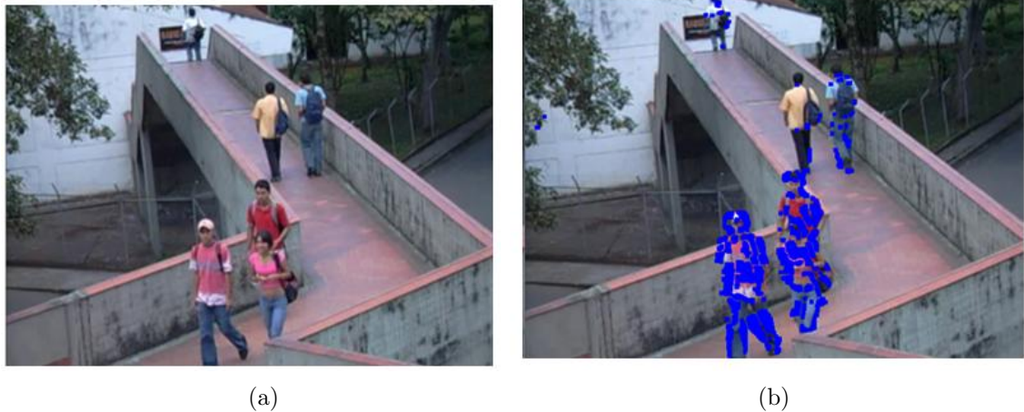
Figura 3.3. Ejemplo de diferenciado temporal. (a) Un ejemplo de la escena con objetos en movimiento. (b) La diferenciación temporal falla en la detección de todos los píxeles en movimiento del sujeto de camisa amarilla debido a su uniformidad de color. Las regiones en movimiento detectadas se marcan con color azul.
