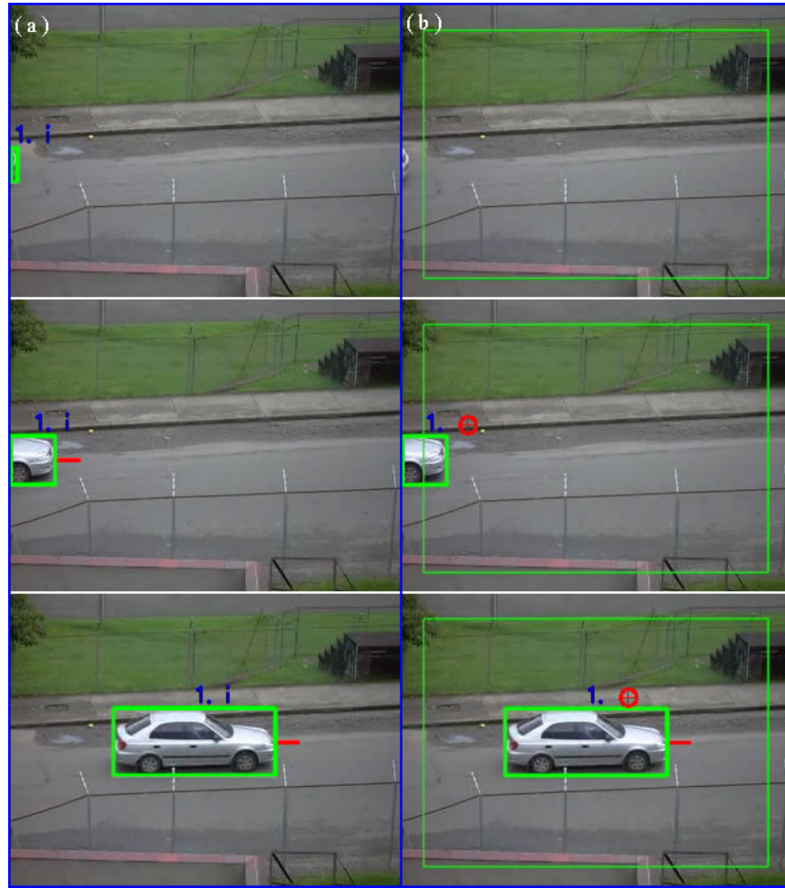
Figura 5.13. Diferencia en reconocimiento de acuerdo a la zona de interés. (a) La región de interés es toda la imagen, el sistema hace la clasificación en el momento en el que el objeto entra en escena. (b) Zona de interés enmarcada en verde, se muestra la clasificación del objeto una vez éste se forme adecuadamente.
