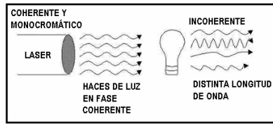
Figura 3.6. Coherencia de un láser y una luz convencional
