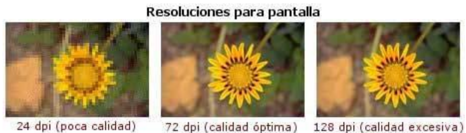
Figura 19. Variación de la calidad de la imagen a distintas resoluciones de pantalla.
