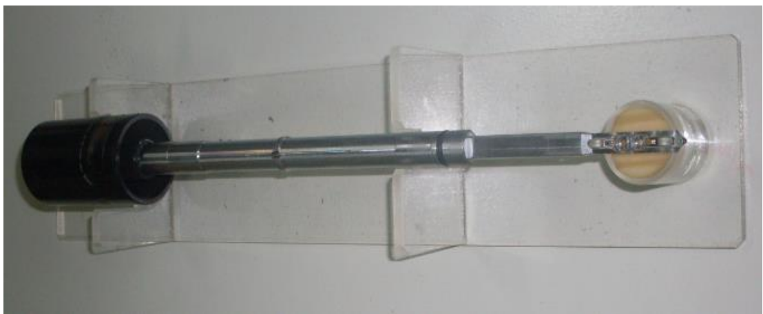
Figura 2.15. Brazo metálico en el que se depositan las rejillas para introducirlas en el microscopio electrónico de transmisión.
