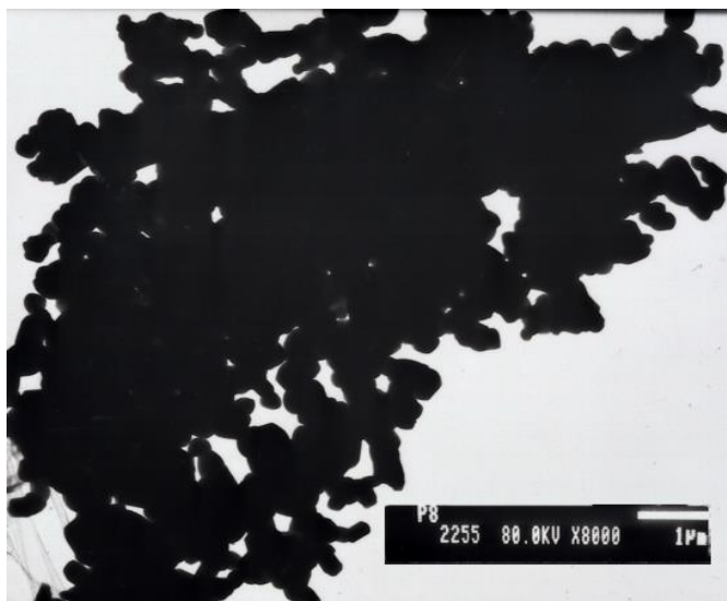
Figura 5.18. Microfotografías TEM de muestras de SBN50 obtenido por el método pechini pH 7,8 a T=1100\text{ }^{\circ}\text{C} por 6 horas.
