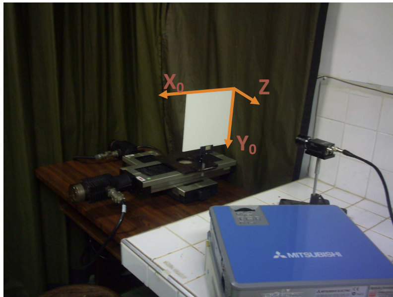
Figura 20. Disposición experimental para la calibración de la coordenada Z .
