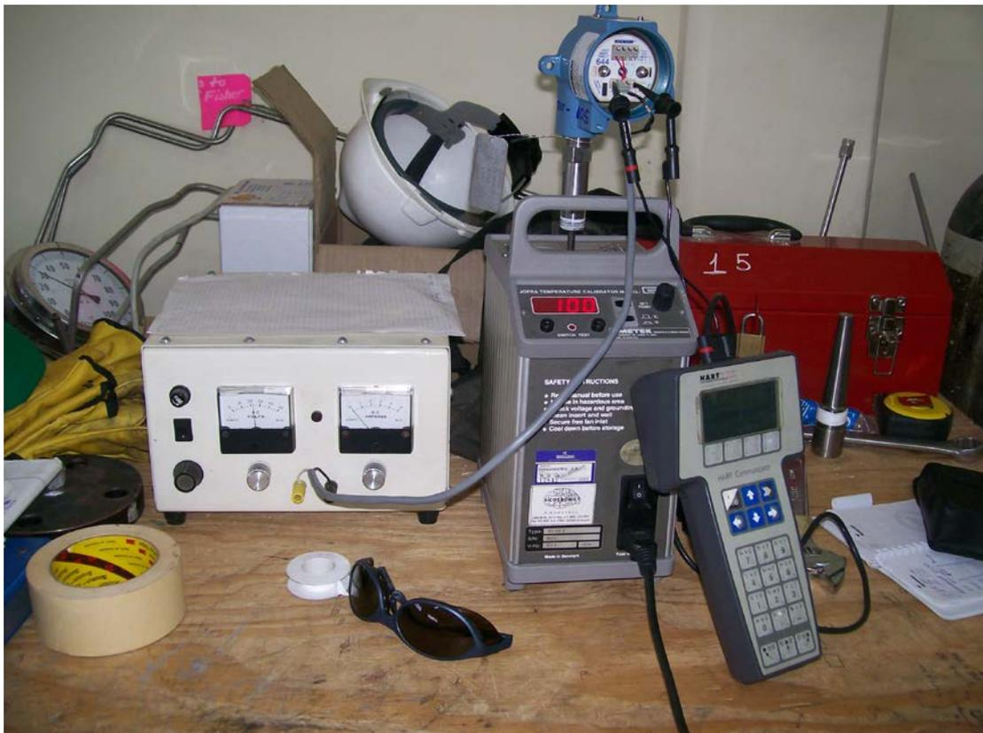
**Imagen 12:** Montaje de calibración para los transmisores de temperatura.
