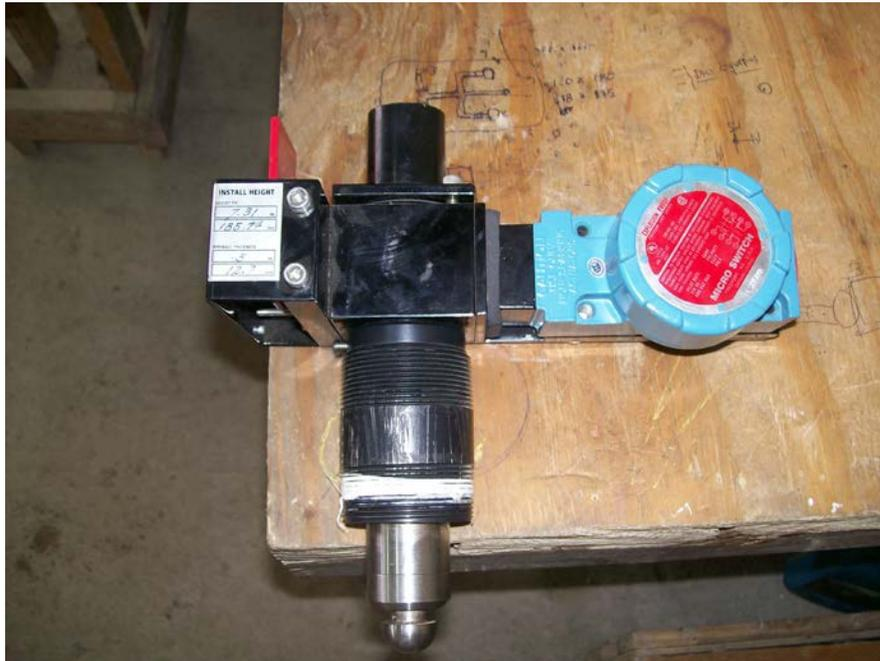
**Imagen 3:** Pulsador que indica el paso de raspador
