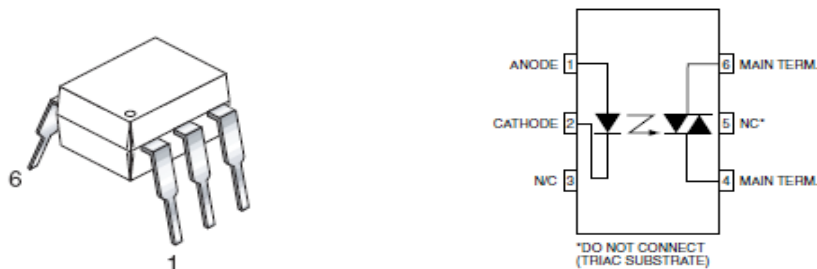
Figura 50: Esquemático y encapsulado del Optoacoplador Moc3022.
