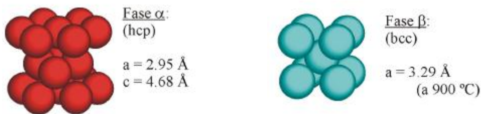
Figura. 60. Estructuras cristalinas del titanio (fases \alpha -Ti y \beta -Ti).
