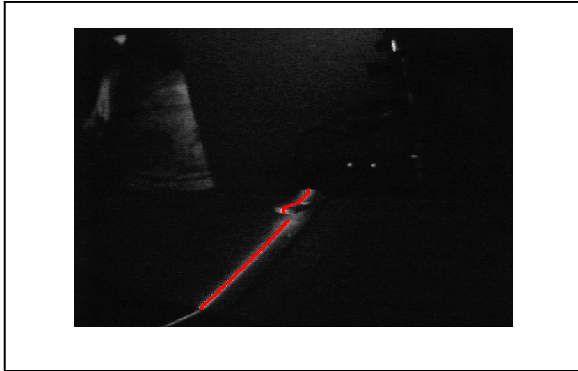
Figura 40. Determinación de los puntos centrales de la línea láser para la Cámara 3
